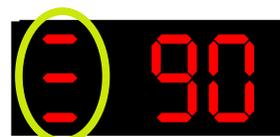
Visualización de la limitación de velocidad y la frecuencia del radar.
