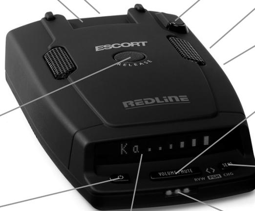
Durante una alerta el display indicará la Banda de radar y una barra gráfica sobre la fuerza de la señal.
