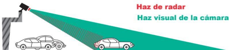
La condición de "haz" imposibilita por tanto que el radar pueda funcionar detrás de peraltes, esquinas u otros elementos opacos a las ondas de radio como metales.
