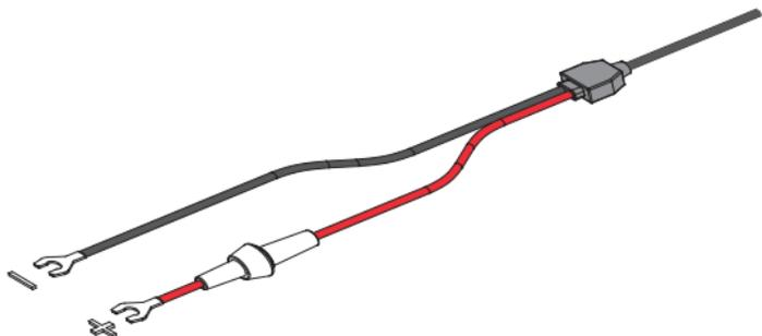
Ahora pase el cable de datos\* (clavija de tres polos) a través del pasamuros del vehículo, y sitúe el terminal cerca de la consola GPS.
