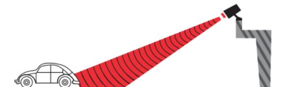
Calcula la velocidad del vehículo a unos 30 metros pasado el pórtico. Baja potencia de emisión y difícil detección.
