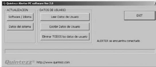
Si el ALERTER no está conectado correctamente, aparecerá la siguiente pantalla: En ese caso, deberá conectar el cable de nuevo.
